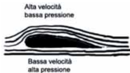
Figura 2 - Il profilo alare e il movimento dell'aria
