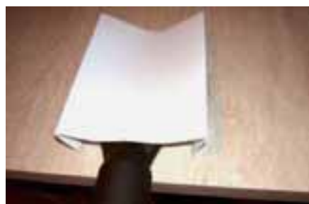
Foto 2 - Il phon spinge l'aria sotto il foglio fissato sul tavolo con il nastro adesivo
